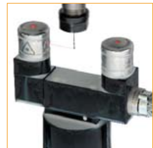
NC4 Compact – безконтактна лазерна настройка на инструменти
